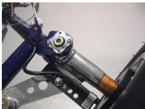
Fixez le câble au châssis en maintenant une large courbe pour permettre à la roue de tourner librement, sans forcer sur le câble. Pensez à faire la boucle assez large pour pouvoir ensuite réajuster le capteur lorsque vous changerez la largeur du train avant.
