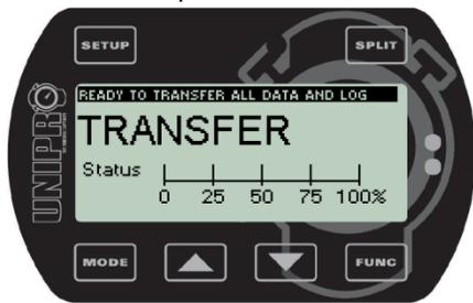
Si le Chrono est réglé pour l'utilisation USB, vous verrez cet écran s'afficher lorsque le câble USB sera connecté. Il montre le statut du transfert USB (sur le PC, une icône apparaît lorsque le câble USB est connecté). Ensuite, choisissez la fonction "Receive" du programme PC Analyser pour commencer le transfert. Lorsque le transfert est terminé, l'écran affiche "Finished".
