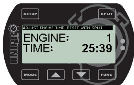
Ensuite utilisez les boutons **▼** et **▲** pour changer les minutes enregistrées sous le numéro du moteur préalablement choisi. Appuyez une fois pour augmenter ou diminuer d'une minute, deux fois pour deux minutes, etc. Appuyez sur le bouton **SPLIT** pour remettre à zéro la durée de fonctionnement. Pour fermer l'affichage d'un numéro de moteur, appuyez sur le bouton **FUNC**.
