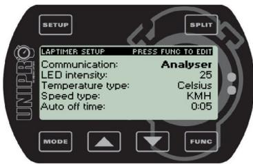
Une connexion typique vers l'extérieur est soit la connexion IrDA (infrarouge) ou USB. Si vous réglez le Chrono de façon à utiliser l'IrDA, vous devez aller dans le mode PC après avoir quitté le mode stand. Si vous utilisez l'USB, le Chrono passera automatiquement en mode PC lorsque le câble USB sera connecté.
