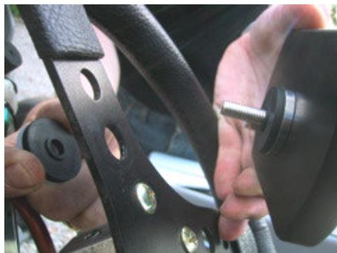
**Premièrement, montez l'écran sur le volant.** Choisissez un trou permettant une bonne assise sur le haut du volant. Sur certains modèles de volants, il peut être nécessaire d'agrandir légèrement le trou.
