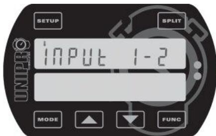
C'est ici que vous définissez le nombre de connecteurs que vous utiliserez. Choisissez la bonne combinaison pour les trois connecteurs de température. Activer/désactiver les connecteurs permet de préserver la batterie d'une décharge inutile et d'ajuster l'affichage de l'écran en fonction de votre propre système.
