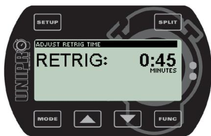
Pour éviter que les récepteurs IR ne s'enclenchent plus d'une fois par tour, choisissez un délai minimum (retrig) d'une valeur inférieure de 2-5 secondes par rapport au temps au tour normal. Une fois ce délai écoulé, le Chrono réactive le récepteur IR qui peut à nouveau s'enclencher. Une fois que le Chrono s'est enclenché, le récepteur se désactive à nouveau.
