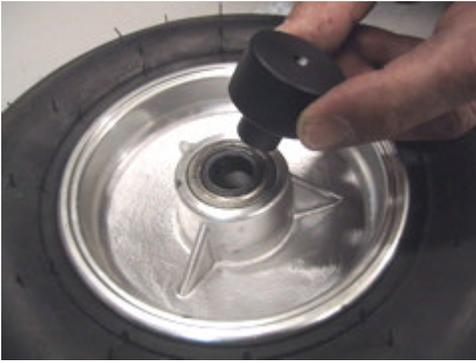
Démontez la roue et placez le dispositif de centrage dans la cage interne du roulement. Si vous utilisez des roues avant à moyeux, vous devez monter le disque capteur sur le moyeu— la technique est la même que celle montrée ici.
