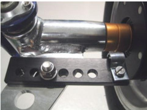
Montez le support du capteur dans un des trous de la fusée de direction. En fonction du modèle de fusée, il peut s'avérer nécessaire d'y percer un trou.
