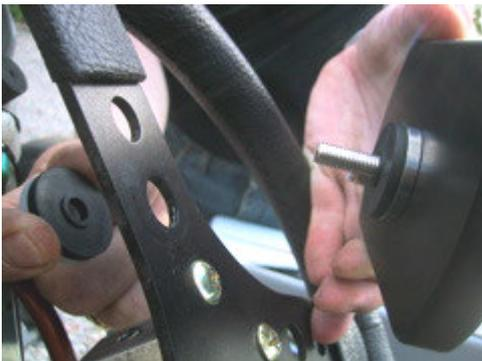
**Premièrement, l'écran est monté sur le volant.** Choisissez un trou permettant une bonne assise sur le haut du volant. Sur certains modèles de volants, il peut être nécessaire d'agrandir légèrement le trou.
