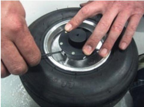
Placez le disque capteur autour du centreur et appuyez fermement dessus. En maintenant la pression, serrez les trois petites vis qui permettent de fixer le disque à la jante. Serrez-les fortement pour ne pas que le disque prenne du jeu en roulant. Après avoir fixé le disque, vous pouvez enlever le centreur et remonter la roue.
