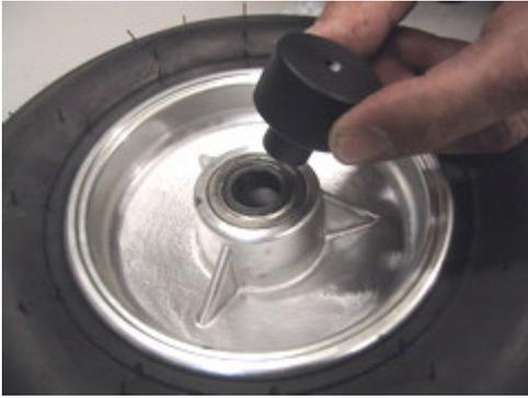
Démontez la roue et placez le dispositif de centrage dans la cage interne du roulement. Si vous utilisez des roues avant à moyeux, vous devez monter le disque capteur sur le moyeu – la technique est la même que celle montrée ici.
