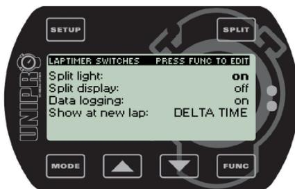
Während Rennen oder Training können „Splitlichter“ einsetzen um angezeigt zu bekommen ob die zuletzt gemessene Splitzeit schneller, gleich oder langsamer gegenüber der besten Splitzeit war. Wenn diese Funktion auf JA gesetzt ist werden die „Splitlichter“ nach dem passieren eines jeden Splitpunktes angezeigt. Grün für eine schnellere, gelb für eine gleichschnelle und rot für eine langsamere
