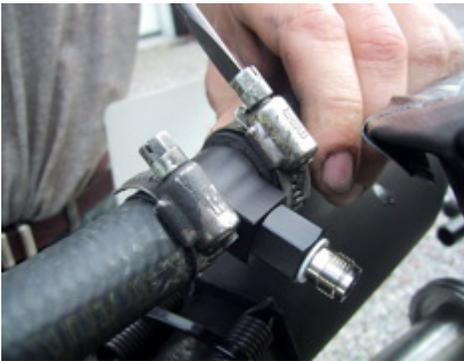
Ziehen Sie die Schlauchschellen an, um das T-Stück in der richtigen Position zu befestigen.
