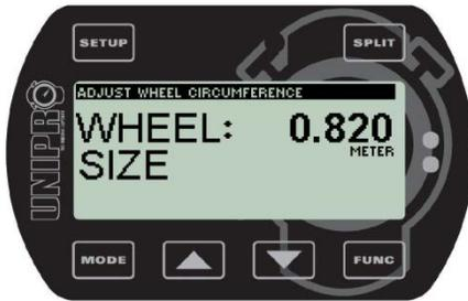
Der Umfang wird in Millimetern eingegeben, sie sollten den Umfang immer wieder messen um alle Messungen genau zu halten. Am besten verwenden Sie hierfür ein flexibles Maßband und messen jedes Mal wenn Sie in die Box zurückkommen. Der Umfang hat Einfluss auf die Geschwindigkeitsmessung, die Laufzeiterfassung des Reifensatzes und die Splitpunkte.
