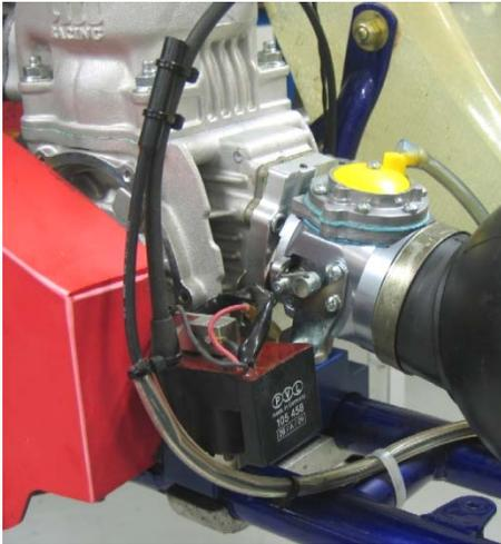
Der RPM Sensor ist Standardzubehör in jedem Unipro Laptimer Kit. Wir nutzen einen aktiven Sensor um ein bestmögliches Signal bei jeder Motorenart sicherzustellen. Befestigen Sie den Sensor mit Sorgfalt, denn Sie möchten sicherlich nicht, dass der Sensor während des Rennens hinunter fällt. In diesem Fall schaltet sich der Laptimer automatisch nach 5 Minuten ab und Sie werden keine weiteren Rundenzeiten mehr auf Ihrem Display sehen.
