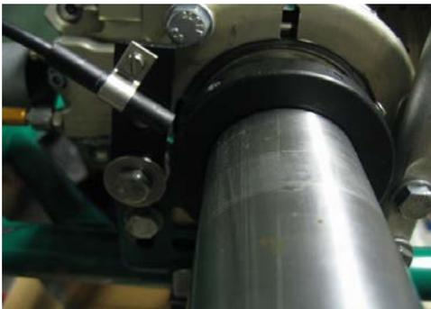
Es ist ebenfalls möglich den Sensor an der Hinterachse einzusetzen.
