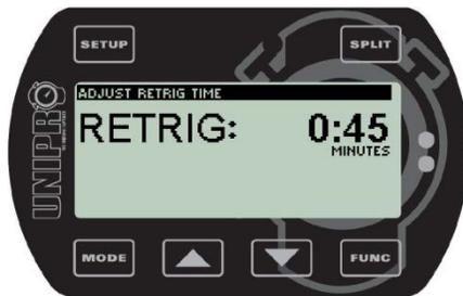
Um dem Problem, dass IR Empfänger mehr als ein Mal pro Runde auslösen vorzubeugen, setzen Sie die niedrige Verzögerung Zeit (Low Delay time) 2 – 5 Sekunden unter der normalen Rundenzeit. Wenn die Zeit verstrichen ist, schaltet der Laptimer den IR Empfänger wieder ein und ermöglicht die Auslösung wieder. Nach dem Auslösen wird der Empfänger wieder ausgeschaltet.
