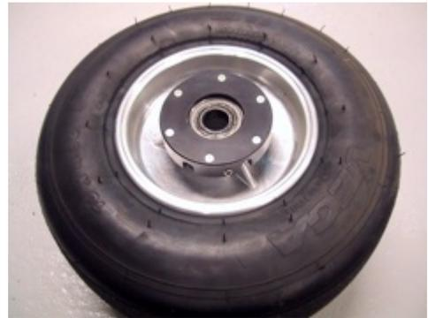
Nachdem die Sensorscheibe montiert wurde kann die Zentrierungsbuchse wieder entfernt werden. Das Rad kann nun wieder am Kart montiert werden.
