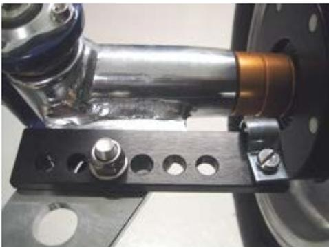
Die Sensorhalterung wird an einem geeigneten Loch am Achsschenkel montiert. Abhängig vom Kartmodell kann es erforderlich sein, dass ein Loch in den Achsschenkel zu bohren.
