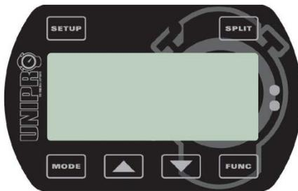
Um den Laptimer auszuschalten drücken und halten Sie die **MODE** Taste etwas länger als eine Sekunde. Sie werden ein leeres Display sehen wenn der Laptimer sich ausschaltet. Falls kein Signal durch den Drehzahlsensor empfangen wird, schaltet sich der Laptimer automatisch nach 5 Minuten selbst aus.
