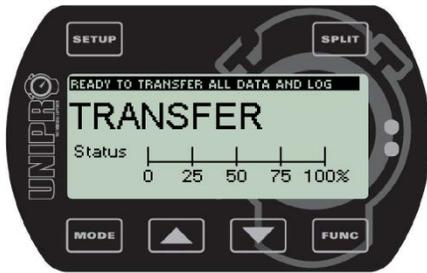
Sobald der Laptimer per USB Kabel verbunden ist erscheint das nebenstehende Fenster. Hier wird Ihnen der Status angezeigt. Anschließend klicken Sie die Übertragung der Daten im PC Analyser an um den Transfer zu starten. Der Fortschritt der Übertragung wird prozentual und in einem Balkendiagramm dargestellt. Wenn das Fenster „Beendet“ (Finished) anzeigt ist die Übertragung beendet.
