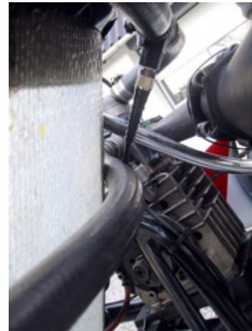
Schließen Sie das Kabel an die Eingänge **TEMP 1** oder **TEMP 2** an die Hauptbox an. Schrauben Sie die Verbindung fest mit den Fingern an.
