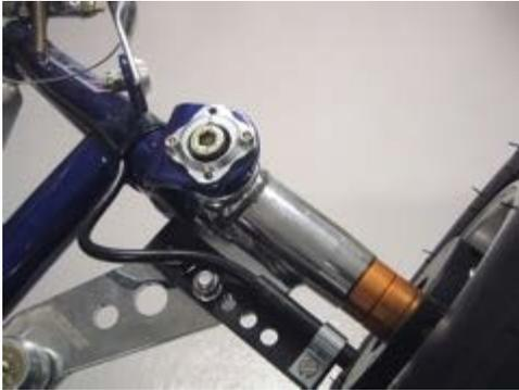
Das Kabel sollte in einem geeigneten Bogen montiert werden, sodass das Rad eingeschlagen werden kann, ohne dass das Kabel gespannt oder gequetscht wird. Bedenken Sie die Schlaufe lang genug zu machen, sodass es möglich ist, den Sensor neu zu justieren, wenn Sie die Spurweite verändern.
