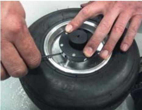
Die Sensorscheibe wird über die Zentrierungsbuchse gesteckt und wird fest nach unten gehalten. Dann ziehen Sie die drei kleinen Schrauben an und fixieren die Sensorscheibe am Rad. Ziehen Sie die Schrauben fest an, sodass diese sich nicht während der Fahrt lösen kann.
