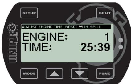
Verwenden Sie die Tasten **▼** und **▲** um die Motorenlaufzeit zu verändern. Jeder Druck ist jeweils eine Minute. Mit drücken der Taste **SPLIT** können Sie den Zähler zurück setzen. Schließen Sie durch drücken der Taste **FUNC** ab.
