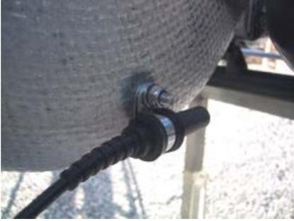
Der Loop Empfänger wird parallel zum Sitz montiert und zeigt nach hinten zur Hinterachse. Stellen Sie sicher, dass nichts zwischen der Strecke und den Empfänger kommen kann.
