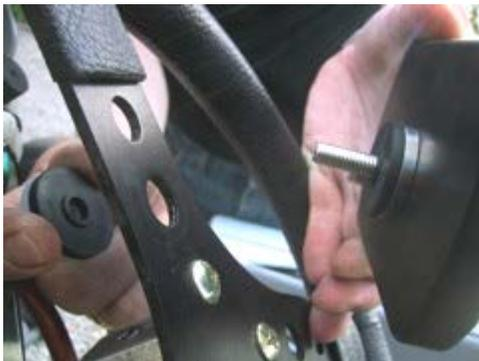
**Zuerst wird die Displayeinheit am Lenkrad montiert.** Wählen Sie hierfür ein Loch welches für sich für eine gute Platzierung im oberen Bereich des Lenkrades eignet. Bei einigen Lenkrädern ist es erforderlich das Loch ein wenig zu vergrößern. Entfernen Sie die graue Scheibe und eine der zwei schwarzen Gummischeiben. Diese Teile werden wie im Bild 1 zu sehen auf der Rückseite des Lenkrades montiert
