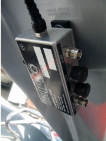
**Stellen Sie sicher, dass das Kabel für die Displayeinheit nach oben zeigt.**
