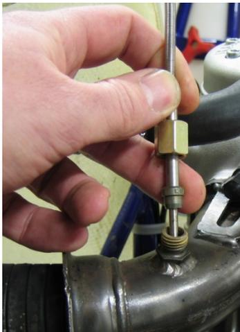
**Montieren des Sensors in der Buchse.**
