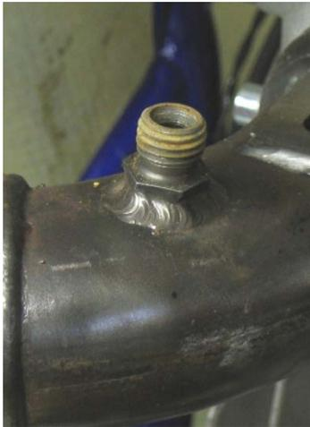
**Verschweißen Sie die Buchse mit dem Auspuff 12-15 cm vom Kolben entfernt.**
