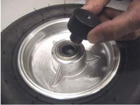
Demontieren Sie das Rad und setzen Sie die Zentrierungsbuchse in den inneren Ring des Lagers. Wenn Sie mit Radsternen fahren, wird die Sensorscheibe auf den Radstern statt auf das Rad montiert – die Methode ist dieselbe wie vorab hier aufgeführt.
