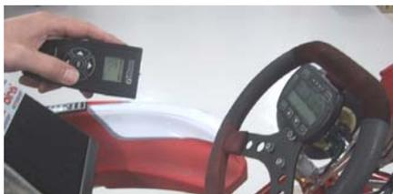
Une fois les données transférées à l'Analyseur de données, elles peuvent être visionnées, stockées, imprimées et transférées vers un PC via un connecteur USB. Il est possible de stocker les données venant d'au moins 20 Chronos embarqués différents avant de les transférer vers un PC.
