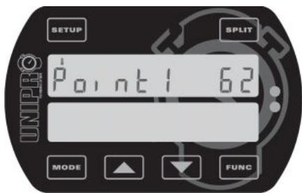
**Voici l'écran de configuration d'alerte de température.** C'est ici que vous définissez un seuil d'alerte pour chaque capteur de température. L'image montre l'établissement du seuil d'alerte de température de l'entrée n°1. Utilisez les boutons ▼ et ▲ pour ajuster ce seuil. Les températures peuvent être affichées en degrés Celsius ou Fahrenheit. Si plusieurs capteurs de température sont activés, vous pourrez
