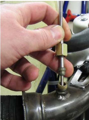
**Placez le capteur dans le filetage.**
