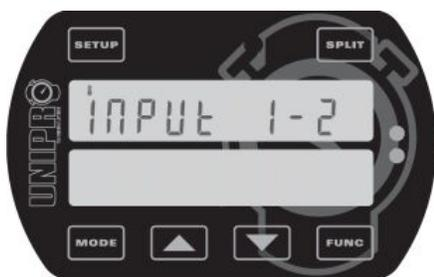
**Voici l'écran des entrées de température.** C'est ici que vous définissez le nombre de connecteurs que vous utilisez. Choisissez la bonne combinaison des trois connecteurs de température. Activer/désactiver les connecteurs permet de préserver la batterie d'une décharge inutile et d'ajuster l'interface de l'écran en fonction de votre propre système.
