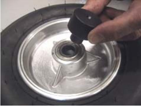
Démontez la roue et placez le dispositif de centrage dans l'anneau interne du roulement.
