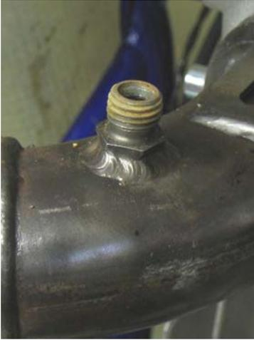
**Soudez le filetage sur la pipe d'échappement à 12-15 cm du piston.**
