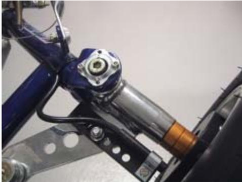
Fixez le câble au châssis en maintenant une large courbe pour permettre à la roue de tourner librement, sans forcer sur le câble.
