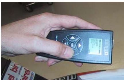
La communication est à présent active et toutes les données du Chrono embarqué (excepté les données filtrées) sont transférées à l'Analyseur de données en quelques secondes. Le LED vert de gauche clignote pendant la réception de données par l'Analyseur et le LED rouge de droite clignote pendant l'émission de données par le Chrono.
