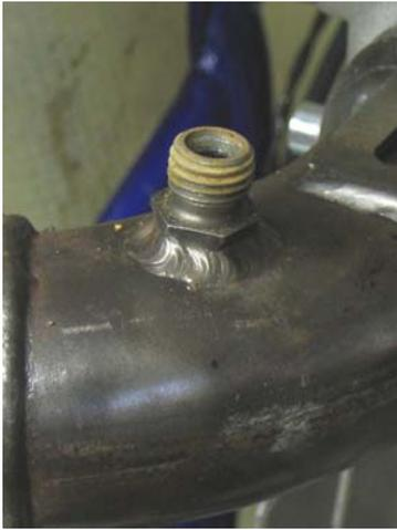
**Schweißen Sie das Gewinde auf dem Auspuffrohr 12-15 cm hinter den Kolben fest.**
