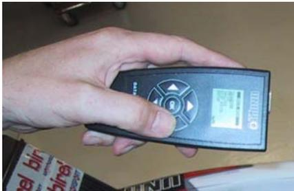
Jetzt ist die Kommunikation aktiviert und alle Daten vom Rundenzähler (mit Ausnahme der gespeicherten Daten) werden zum Datenanalyser in wenigen Sekunden übertragen.
