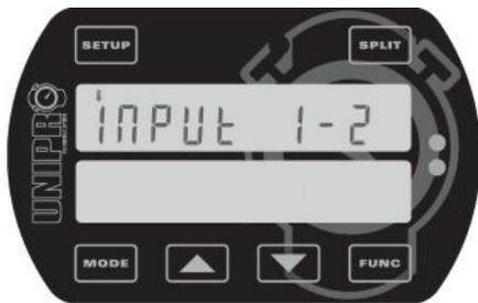
**Dies ist das Temperatureingabe-Display.** Hier definieren Sie, wie viele Temperatureingaben, Sie benutzen. Wählen Sie die richtige Kombination der drei Temperatureingaben. Der Grund für das Ein- und Ausschalten ist Batterien zu sparen und um die Bedienoberfläche zum eigentlichen Setup anzupassen.
