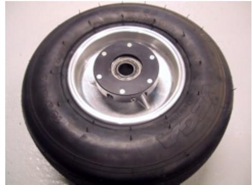
Nachdem die Sensorscheibe angebracht worden ist, wird die Zentrierhilfe wieder entfernt. Jetzt kann das Rad erneut montiert werden.
