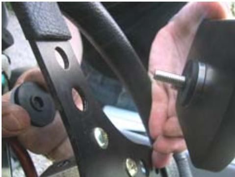
**Zunächst wird die Displayeinheit auf dem Steuerrad montiert.** Wählen Sie ein Loch, das eine gute Position oben auf dem Steuerrad erlaubt. Bei manchen Steuerrädern ist es notwendig, das Loch ein wenig zu vergrößern. Entfernen Sie die Mutter, die graue Scheibe und *eine* der zwei schwarzen Gummischeiben. Diese Teile sind auf der Rückseite des Steuerrads montiert, wie in Bild 1 gezeigt.
