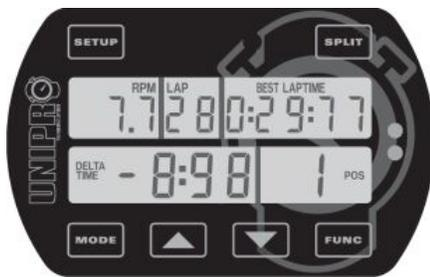
Wenn der Rundenzähler die Ziellinie passiert, zeigt er den Unterschied zwischen der aktuellen Runde und der besten Runde und die Position. Im gezeigtem Beispiel, ist die aktuelle Runde 8,98 Sekunden schneller als die letzte beste Runde und die aktuelle Runde ist die beste Runde (in Position 1). Diese Information wird 5 Sekunden gezeigt, bevor wieder zurückgeschaltet wird zum Datendisplay.
