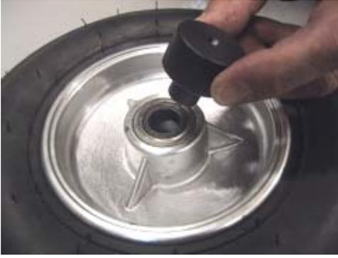
Nehmen Sie das Rad ab und platzieren Sie die Zentrierhilfe in dem inneren Ring des Kugellagers.
