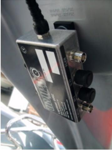
**Stellen Sie sicher, daß das Kabel der Displayeinheit nach oben zeigt.**
