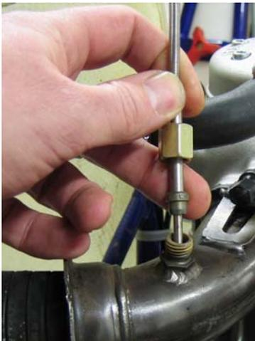
**Montieren Sie den Sensor in dem Gewinde.**
