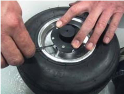
Die Sensorscheibe wird über die Zentrierhilfe geschoben und fest nach unten gedrückt. Anschließend werden die drei kleinen Schrauben, die die Sensorscheibe am Rad befestigen, festgeschraubt. Drehen Sie die Schrauben fest, so daß die Sensorscheibe sich nicht während der Fahrt löst.
