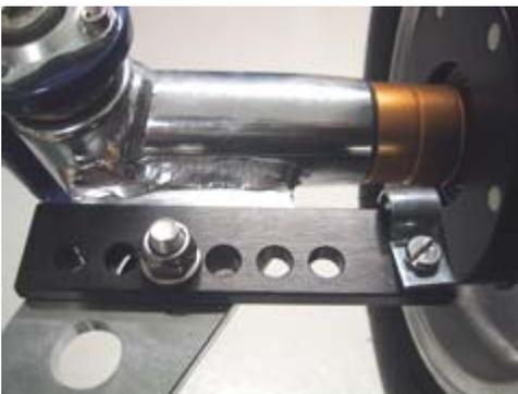
Der Sensor wird in einem passenden Loch im Lenkgestänge montiert. Abhängig vom Kartmodell, kann es notwendig sein, ein Loch im Lenkgestänge zu bohren.
