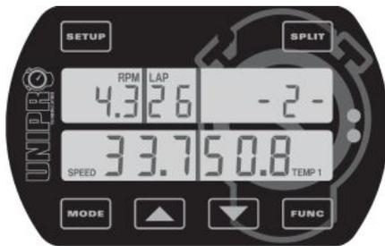
Wenn der Rundenzähler eingeschaltet worden ist mit der **MODE** - Taste, fängt er in der Erste-Runde-Modus an. Dies ist der Teil des Rennens von der Box zur Ziellinie zum ersten Mal.
