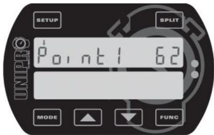
**Dies ist das Display für die Temperaturwarnung.** Hier können Sie einen Warnpunkt für jeden aktiven Temperatursensor definieren. Das Bild zeigt die Einstellung des Temperaturpunktes 1. Benutzen Sie die ▼ und ▲ Tasten um den Temperaturpunkt einzustellen. Die Temperaturen werden entweder in Grad Celsius oder Fahrenheit gezeigt. Falls Sie mehr als einen
