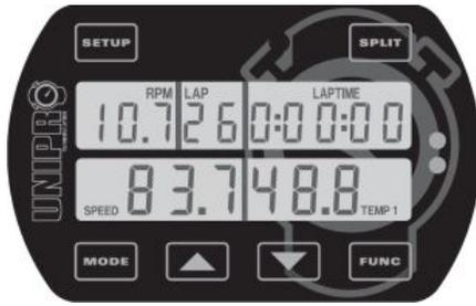
Wenn die Ziellinie das erste Mal überfahren wird, zeigt das Display 0:00:00 um anzuzeigen, daß der Zähler gestartet wird.
