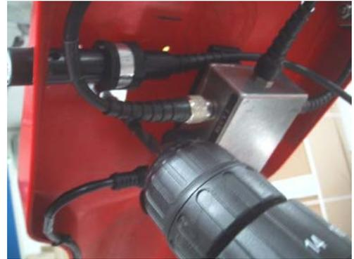
Das Kabel wird an der Buchse angeschlossen mit der Markierung **RECV 2** auf der Haupteinheit. Drehen Sie den Stecker mit den Fingern fest zu.
