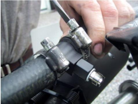
Drehen Sie die Schlauchschellen fest um das T-Stück an der richtigen Stelle zu befestigen.
